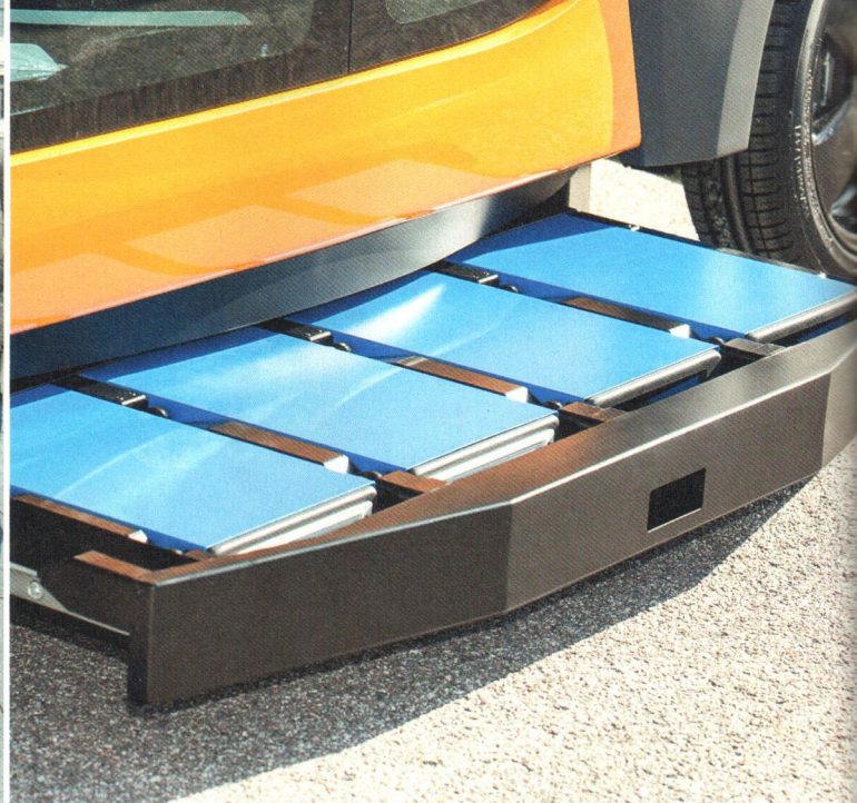
Geballte Ladung an Bord: Die Batterien sind in einer Schublade unter dem Auto gut zugänglich.
